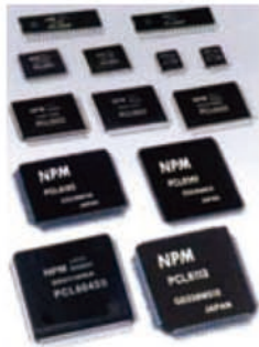
PCL系列 电机控制用脉冲LSI
